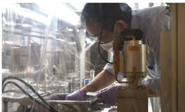
BL-19A に設置された走査型X線顕微鏡（STXM）に試料をセット（2021 年 6 月）
