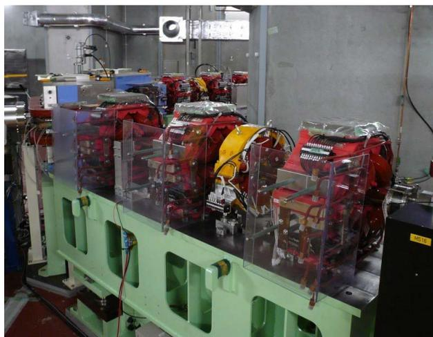
図 3-1 第 1 アーク部に設置されたバンチ圧縮用の六極電磁石(黄色)
