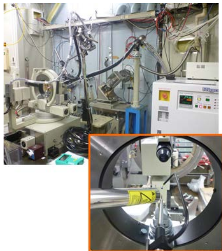
図1 BL-6C内に設置された吹付け型低温装置。4軸回折計AFC-5で使用の様子。
