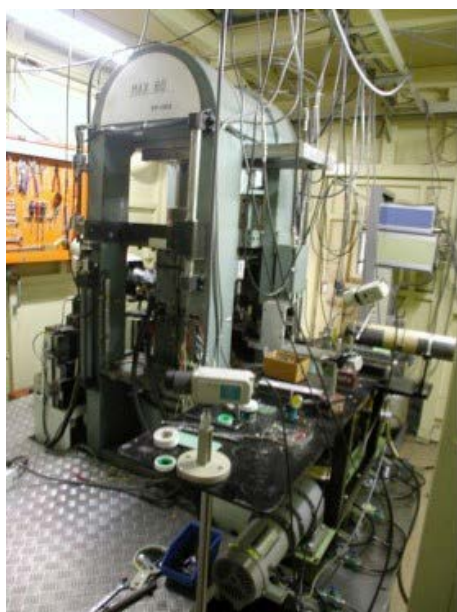
図1 AR-NE5C実験ハッチに設置されているMAX80と呼ばれる500トンプレス。中心部にDIA型高压発生装置が組み込まれている。右上上流に放射光光源があり、白色X線が実験ハッチに導かれる。
