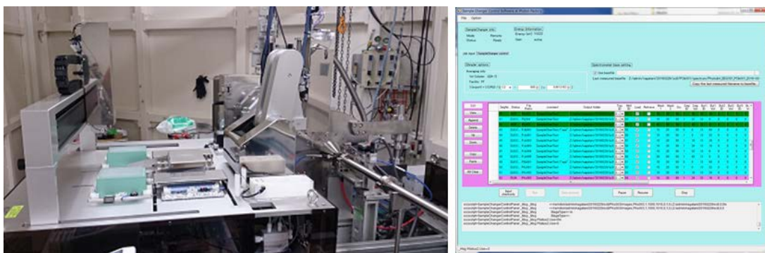
図 1 BL-15A2 に開発した溶液サンプルチェンジャー (SSC) と測定制御ソフトウェア
