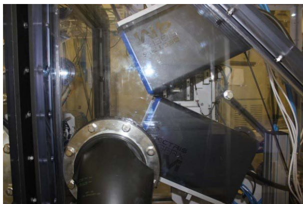
図1 グヘリウムチャンバー内の2台のEiger検出器
