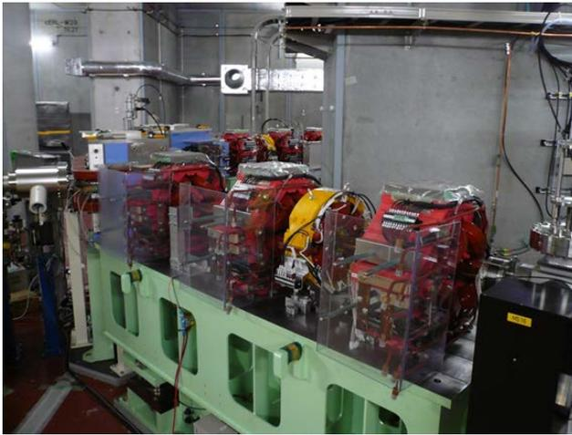
図2 共通架台の上に設置されたバンチ圧縮用の6極電磁石（黄色の電磁石）です
