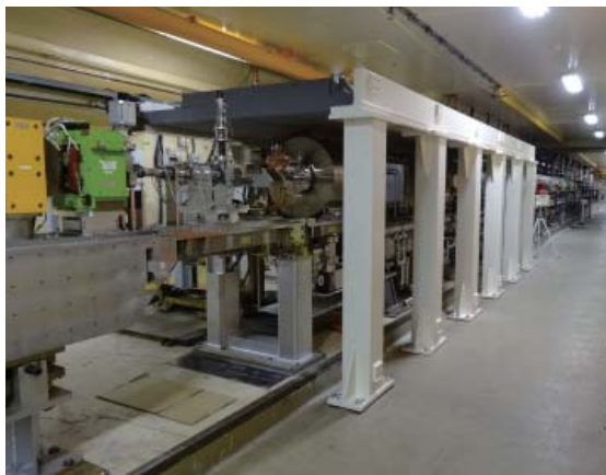
図1 陽電子発生装置(上)と、その上に設置された遮蔽(下)。現在の遮蔽は鉄20 cm。
