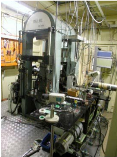
図1 AR-NE5C実験ハッチに設置されている500トンプレス(MAX80)。中心部にDIA型高压発生装置が組み込まれている。右上流に放射光光源および二結晶分光器があり、白色/単色X線が実験ハッチに導かれる。白色X線を用いたXRD測定のためのGe半導体検出器や単色X線を用いたXAFS測定のための電離箱が設置されている。
