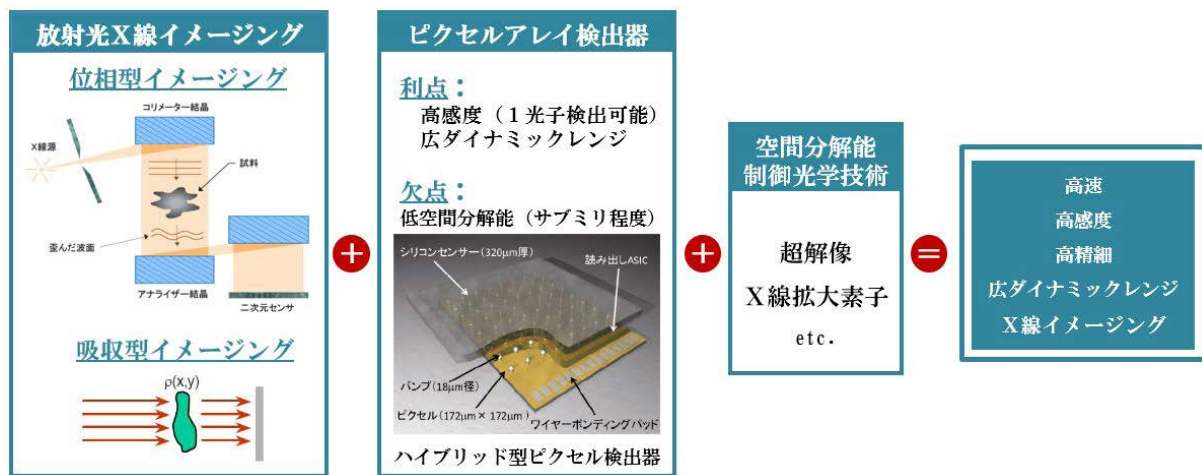
図3 高輝度放射光・高性能X線検出器・高度なX線光学技術の融合が拓く高速・高感度・高精細・広ダイナミックレンジの in situ マルチスケールX線イメージングの世界
