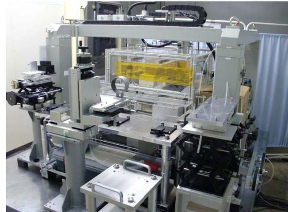
図3 BL-14C X線イメージング用実験装置
