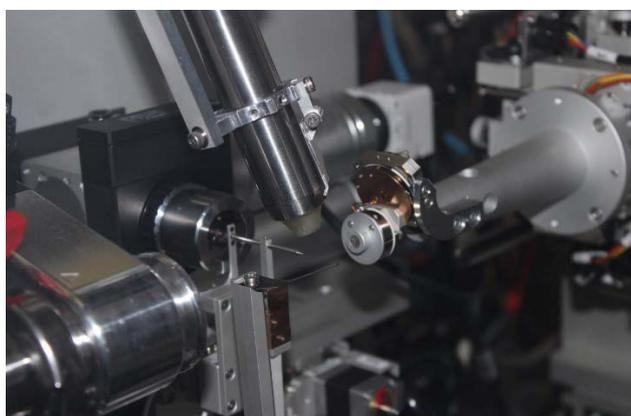
図1 試料位置周辺。コリメーションシステム更新、アニーリングスクリーンの導入、ミニカップゴニオメータの改良を行った。
