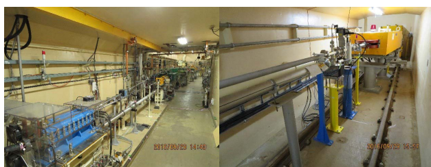
図4 PF-AR 直接入射路の LINAC-SY3 の分岐点。手前のパルス偏向電磁石で PF-BT, PFAR-BT, KEK-BT が分岐する(左図)：SY3 のダンプレインを通過する PFAR-BT (右図)。
