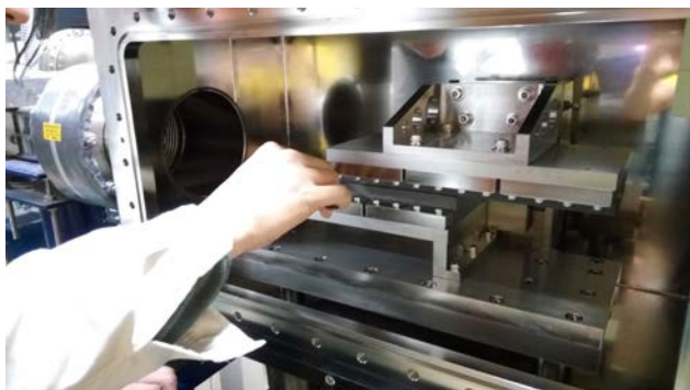
図1 高次光除去ミラーの調整の様子
