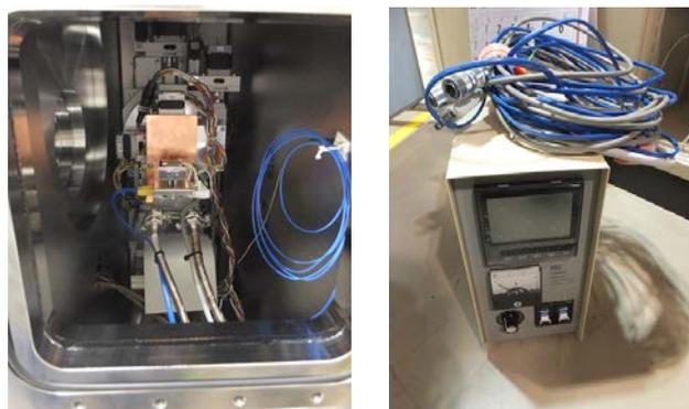
図3 (左) Tender- X線を利用したGISAXS測定のために導入されたヒーターユニット(坂口電熱)。 (右) ヒーターコントローラユニット(LABOX-126-899, 理化工業)。
