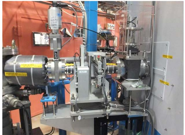
図1 更新されたBL-6Aのビームサイズ成形スリット(S1スリット)
