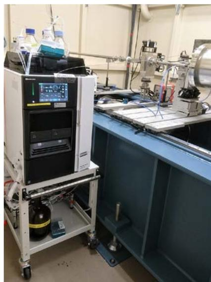
図1 新規導入されたHPLCシステムNexera-i(島津製作所)
