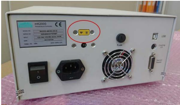
図2 Instec 社製加熱冷却ステージコントローラ (MK2000)。改造に伴い熱電対の接続ポートが増設された (赤丸)。
