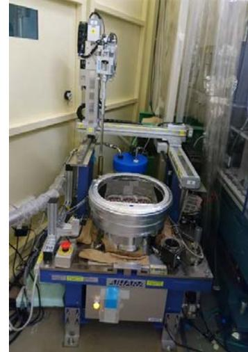
図2 BL-1A サンプルチェンジャーに設置されたデュアルデュワー。手前が試料を設置するメインデュワーで奥がサブデュワー。安定な液体窒素の補充を実現するとともに、メインデュワーへフタ設置が可能となる。
