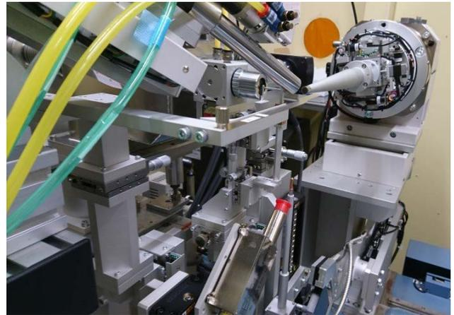
図2 更新された回折計。同軸顕微鏡、大型サンプルに対応可能なビームストッパー等を備える。
