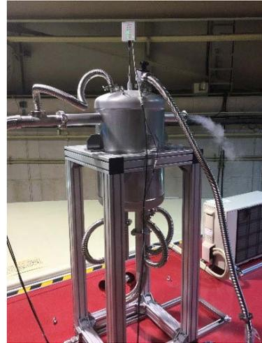
図2 液体窒素気液分離装置
