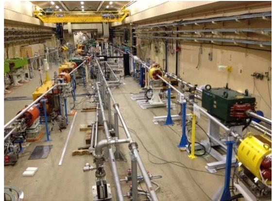
図 2 入射器端末の第 3 ビーム・スイッチ・ヤード。右から、PF リング、PF-AR、直線ダンプ、SuperKEKB LER（陽電子）、HER（電子）、東ダンプ、の各ビームライン。
