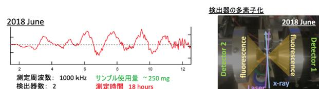
図 1 2 台の検出器 (プラスチックシンチレーター + PMT) を導入したシステムで測定された、Re 光触媒錯体の反応中間体構造 ( $\tau \sim 100$  ns) における過渡差分 EXAFS スペクトル。
