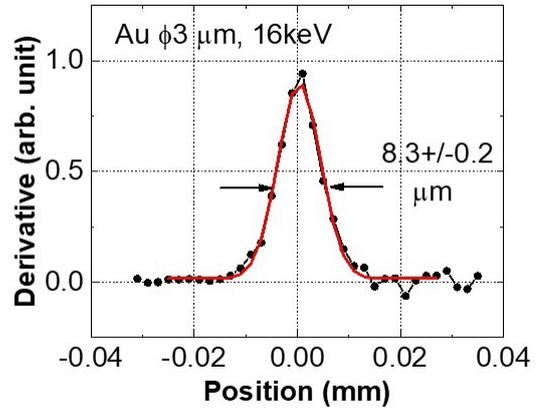
図 2 穴径 3  $\mu\text{m}$  金製 (厚さ 90  $\mu\text{m}$ ) ピンホールを使って得た 16 keV の X 線マイクロビーム。縦 7  $\mu\text{m}$ ・横 8  $\mu\text{m}$  と評価された。図は横方向の結果。
