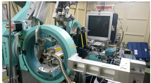
図 1 (上) 高圧 X 線回折用に新規に導入した入射 X 線成形システム (X 線レンズおよびコリメーションシステム)。(下) 大型フラットパネル検出器による高圧 X 線回折測定セットアップ。
