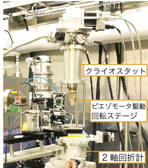
図1 極低温蛍光X線ホログラフィー測定装置
