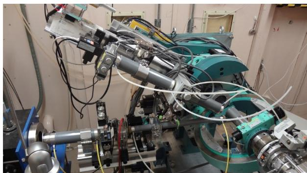
図 1 4 軸回折計に He 循環型冷凍機を搭載して実験中。20 アーム上に、試験利用している 2 次元 X 線検出器が搭載されている。
