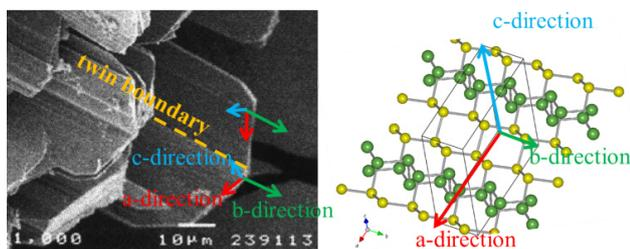
図2 結晶の外形と原子配列，双晶境界を示す。シミュレーションにより構造が最適化でき、d軌道の重要性，機能物性など明らかにされた [1]。
