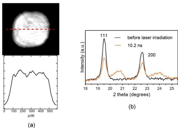
図3 (a) 試料位置における約 500 μm 径のフラット領域を持つビームプロファイル。(b) (a) のビームプロファイルを用いて行ったアルミニウムの時間分解 X 線回折測定。レーザー照射後 10.2 ns のときに衝撃圧縮を示す高角側へのシフトが確認できる。
