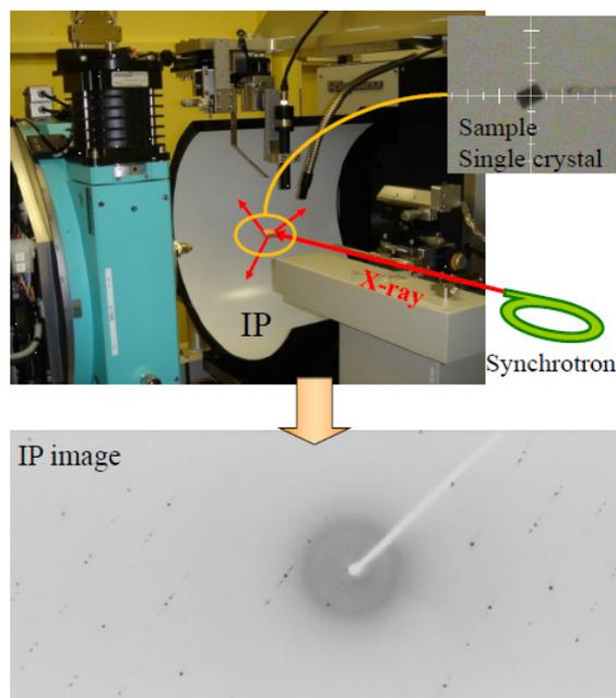
図1 BL-8Aに設置されているIP回折計
