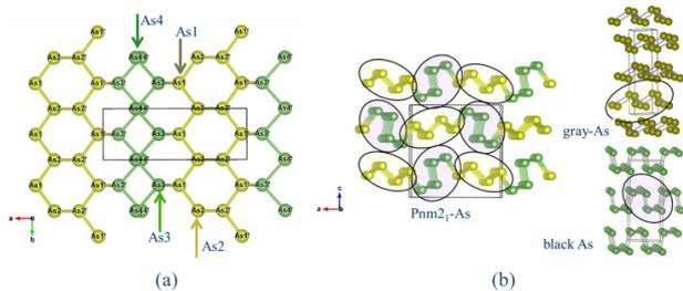
図1 第三の単体ヒ素の構造。白燐構造部位と黒燐部位が規則配列し、同元素間で電子の供与・授与が起り、それぞれの部位は正と負に帯電している [1]。
