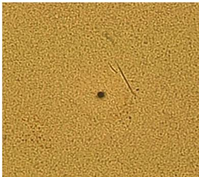
図 1 穴径 3  $\mu\text{m}$  金製 (厚さ 90  $\mu\text{m}$ ) ピンホールの写真 (光学顕微鏡 500 倍。中心部にピンホールが見えている。)
