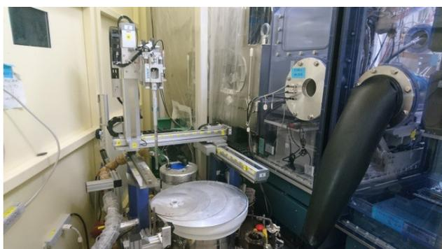
図1 BL-1A サンプルチェンジャーのデュアルデューワーとメインデューワー上に設置されたスライド式のフタ。フタの設置により、メインデューワー内への霜混入、補充される液体窒素量を共に低減できた。
