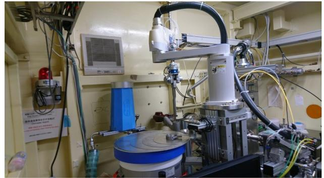
図 1 BL-5A のサンプルチェンジャー。メインデューワーにスライド式のフタを導入した。奥に見えているフォームデューワーが、液体窒素供給ラインに挿入されたサブデューワー。
