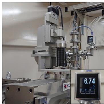
図1 カメラ長用真空パスのピラニー真空ゲージ(THERMOVAC TTR101N, Leybold)
