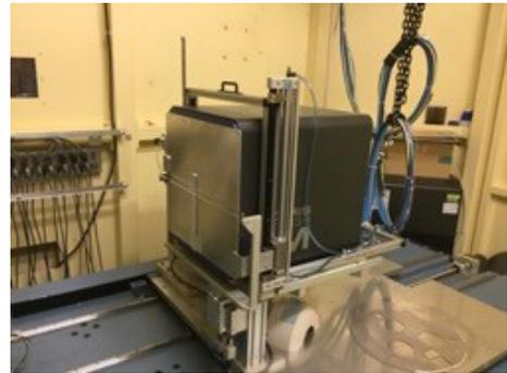
図2 ビームラインに設置された PILATUS3 S2M (DECTRIS 社製)
