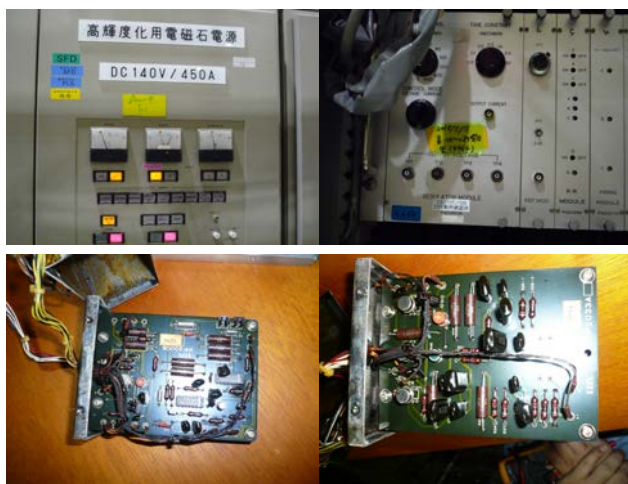
図2 PFリング立ち上げの5月7日に故障したSFD(6極電磁石:1994年製造)電源。上下図の黒いダイヤルが3つについているモジュールが故障したモジュールで、下図がモジュール内部の基板。内部基板は焦げ、抵抗2個破裂、配線も焦げているのが分かった。
