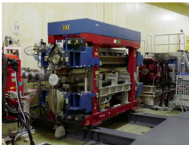
図2 内面に NEG コーティングされた U#19 用の新しい真空チャンバー
