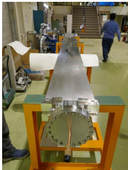
図2 内面に NEG コーティングされた U#19 用の新しい真空チャンバー
