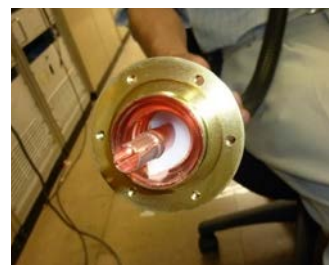
図8 故障した HOM ケーブルの端のコネクタ (HOM カップラー側) を外したところ。絶縁体のポリエチレンは健全であった。
