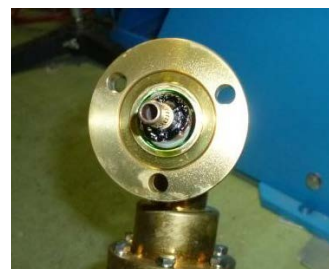
図6 故障した HOM ケーブルに付属する L 型アダプタ (ダミーロード側)。絶縁体のポリエチレンが黒色に変色していた。
