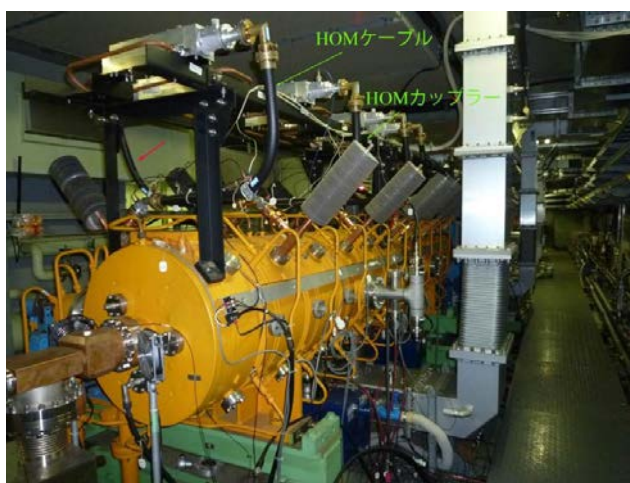
図5 PF-AR 東直線部の APS 空洞 (E-4) の写真 (5/28 撮影)。空洞当たり12個の HOM カップラーが取り付けられ、取り出した HOM 電力は HOM ケーブルを通して3 kW 水冷ダミーロードに導かれる。今回交換した後の HOM ケーブルを赤色矢印で示す。
