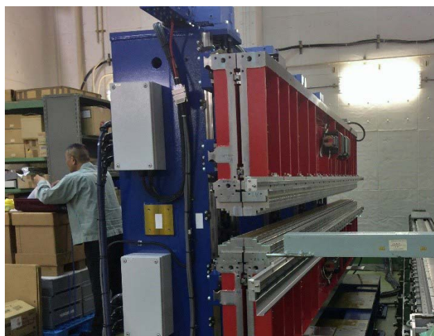
図3 PF-AR 北棟挿入光源準備室で磁場調整中の新しいアンジュレータ (U#19)
