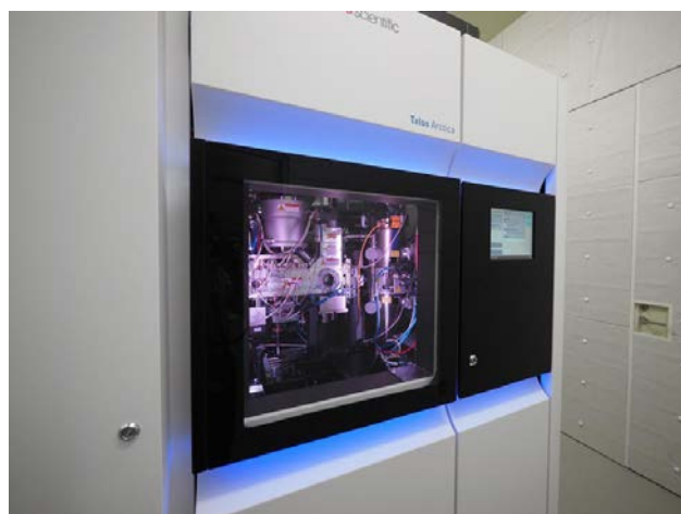
図 1 構造生物学研究センターに導入された 200 kV のクライオ電子顕微鏡。Thermo Fisher 社の Talos Arctica という機種で，測定試料を自動的に交換するオートローダーという機構が付いている。
