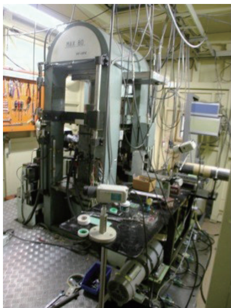
図 1 AR-NE5C 実験ハッチに設置されている 500 トンプレス(MAX80)。中心部に DIA 型高压発生装置が組み込まれている。右上上流に放射光光源および二結晶分光器があり、白色/単色 X 線が実験ハッチに導かれる。白色 X 線を用いた XRD 測定のための Ge 半導体検出器や単色 X 線を用いた XAFS 測定のための電離箱が設置されている。
