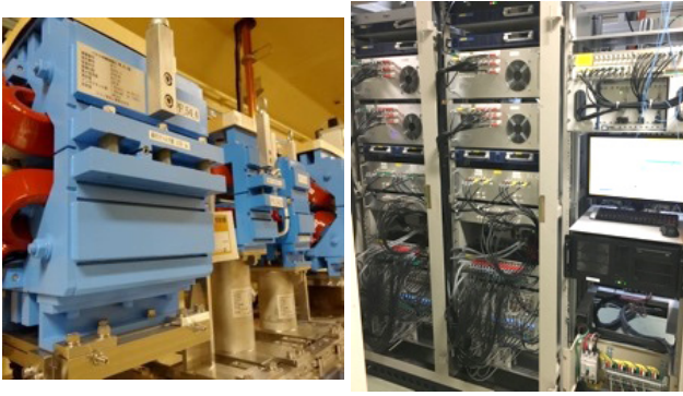
図6 パルス収束電磁石, パルス補正電磁石 (左), 電源とコントローラを収めた筐体 (右)。
