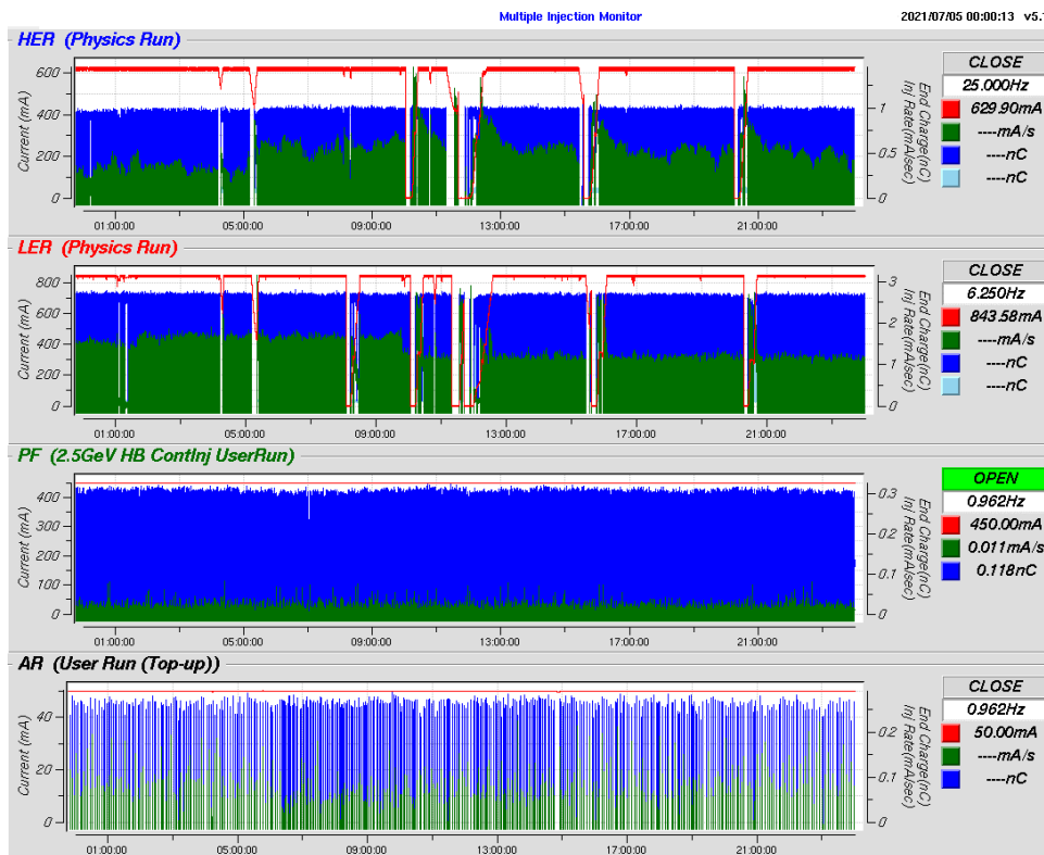
図1 入射運転の典型例として、運転停止直前7月4日24時間について、上段から SuperKEKB HER、LER、PFリング、PF-ARの4蓄積リングへの入射の様子を蓄積電流(赤mA)、入射電荷(青nC)、入射率(緑mA/s)で示す。
