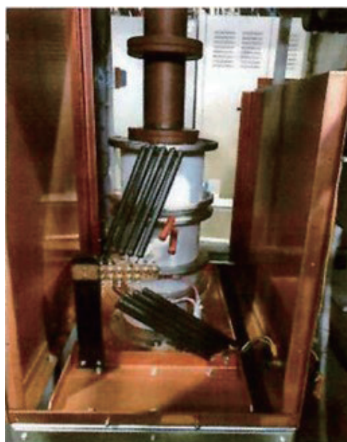
図 2-4 過熱損傷したトランス(左)及び交換したサイラترونの実装状態(右)。
