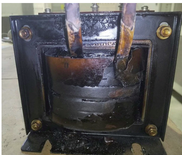
図 2-4 過熱損傷したトランス(左)及び交換したサイラترونの実装状態(右)。
