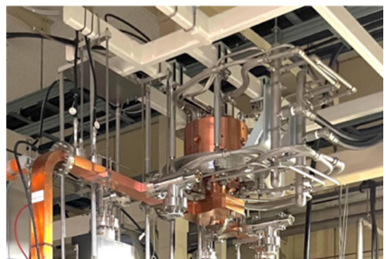
図2 パルス圧縮器新旧比較(上: 現行 SLED 下: 新型 SCPC)
