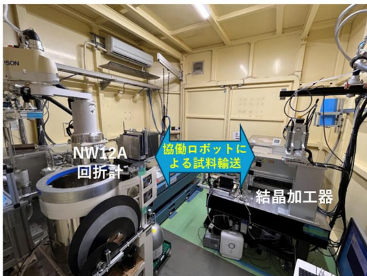
図1 結晶加工器が移設されたNW12A実験ハッチ内
