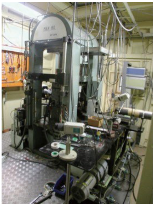
図 1 AR-NE5C 実験ハッチに設置されている 500 トンプレス（MAX80）。中心部に DIA 型高压発生装置が組み込まれている。右上上流に放射光光源および二結晶分光器があり、白色 / 単色 X 線が実験ハッチに導かれる。白色 X 線を用いた XRD 測定のための Ge-SSD や単色 X 線を用いた XAFS 測定のための電離箱などが設置されている。
