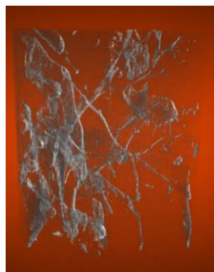
図 2. 実験室回折格子干渉計を用いて測定したラットの肝臓のCT像
