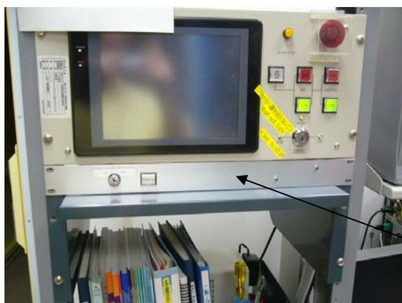
BL-5A、BL-17A、AR-NW12Aに結晶交換ロボットと実験ハッチドアとのインターロックを導入しました。
