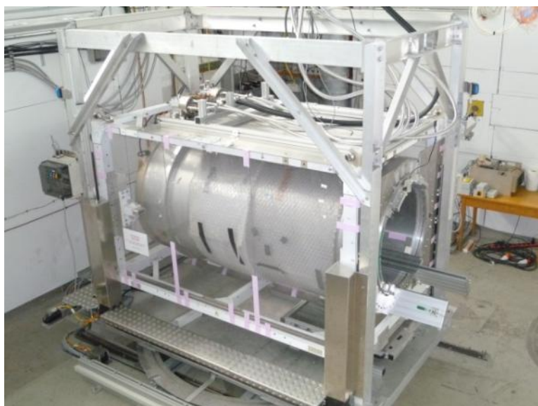
図 4 DESY にて稼動開始した無冷媒超伝導ソレノイド
