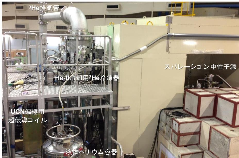
図4 第2世代UCN源の建設状況 2013年度中に図3左のEDM装置を接続する予定。
