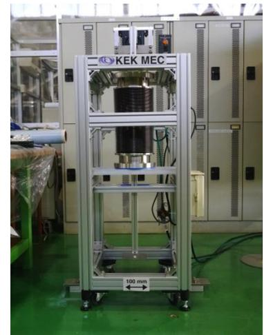
図 6 : コンベンショナル陽電子源用振り子ターゲットのプロトタイプ
