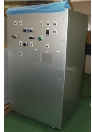
図 5 : 圧縮機式 2 相 CO<sub>2</sub> 循環冷却システム
