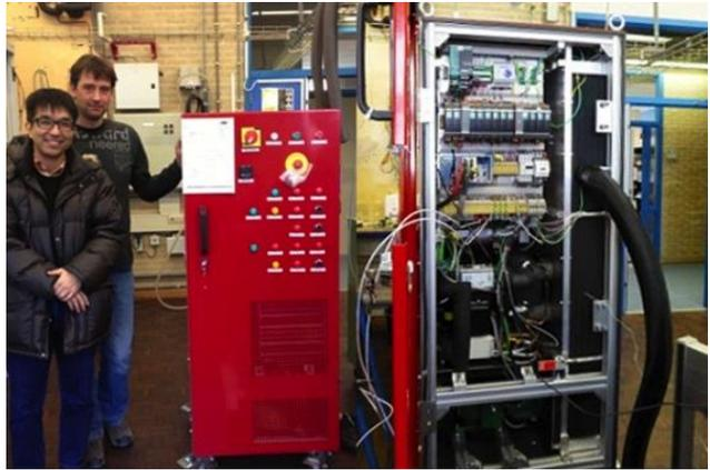
図 4: LCTPC 開発研究用小型 2 相 CO<sub>2</sub> 循環冷却システム（液体ポンプ式）
