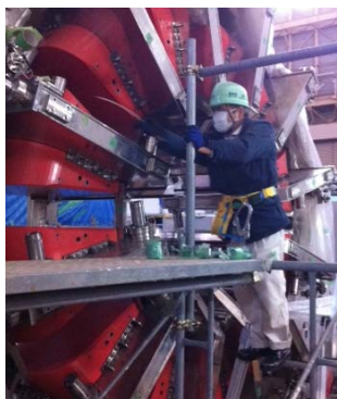
図1 超伝導トロイダル磁石真空容器整備作業（左）及び冷凍機内視チェック（アルミプレートフィン熱交換器）（右）
