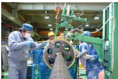
図 1 製作中の超伝導電磁石コイル
