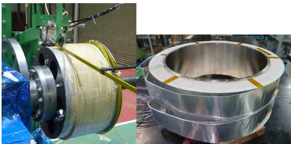
図 2 捕獲ソレノイドコイル TS1a (左) 及び輸送ソレノイドコイル (TS2) の製作
