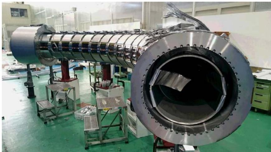
図2 COMET 輸送磁石(湾曲ソレノイド TS2)の製作
