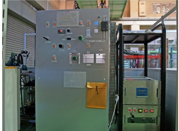
図 6 液化ユニット (左)、流量計ユニット、冷却ユニット (右のラックに設置) からなる 2 相 CO2 冷却システム
