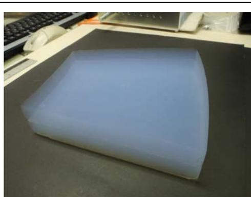
図 3: 製作された透明度のよいエアロゲルの写真
