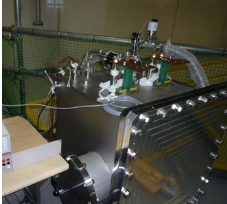
図2 輸送ソレノイド用電流導入部
