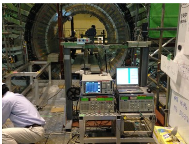
図 2：Belle-II TOP 検出器の EMC 環境試験。Belle-II 構造体にインストールされた状態でやっている。
