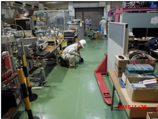
通路に物品が置かれ幅が十分に確保されていない。 (避難経路明示の作業中)
