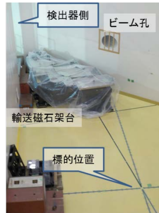
図6 正規の位置に設置された 輸送ソレノイド用架台
