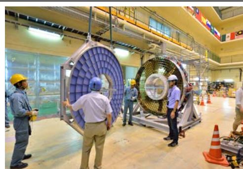
図 5 : エアロゲル部と光センサー (HAPD) 部の合体直前の ARICH
