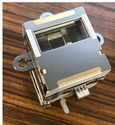
図8 開口部中央に半導体検出器が見える。表面から放出された二次電子は、下部にある電子増幅器で時間信号に変換される。
