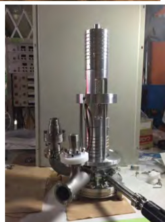
図9 mini-MRTOF-MS コンパクト化を進め、既存の約半分の全長となっている。
