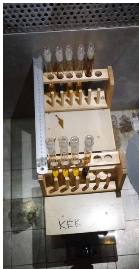
図 5 : 陽電子生成ターゲットの回転真空シールに用いる磁性流体の耐放射線特性試験 (於: 高崎量子応用研究所)
