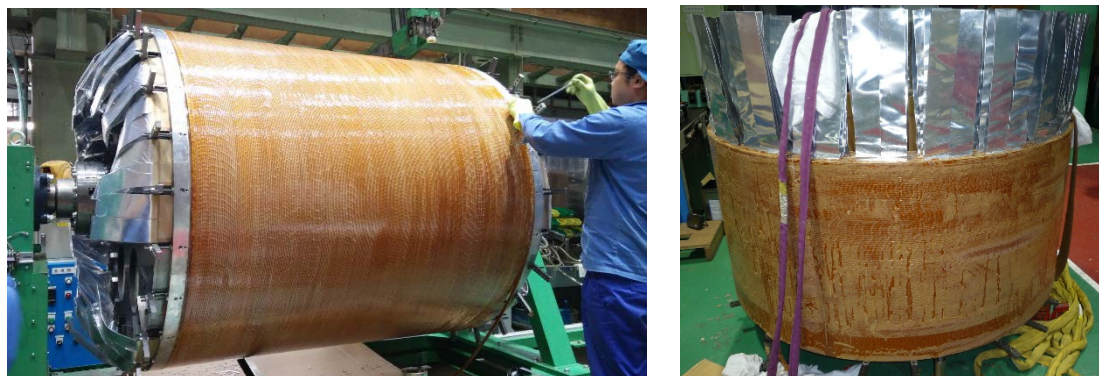
図 2 COMET 超伝導磁石、Matching Solenoid 1 (左) と MS2(右)
