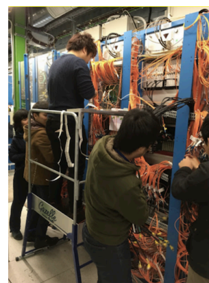
図2: CERNでミュオントリガー用の新しいボードをインストールしている様子
