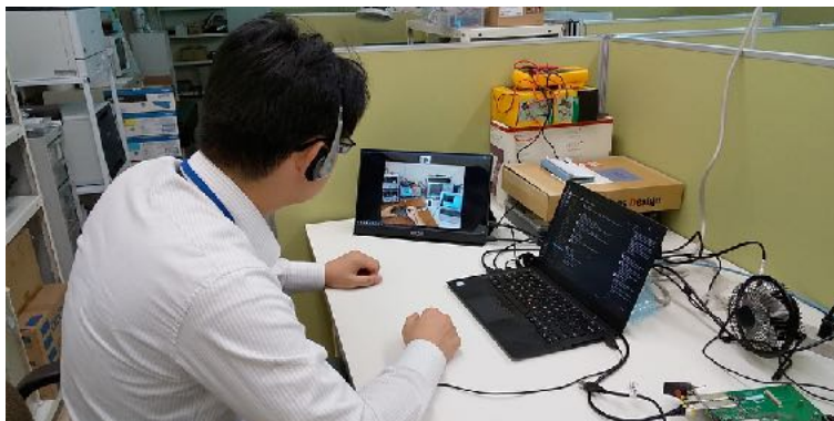
東海キャンパスでスマートグラスに映った画像をもとに状況を把握しアドバイスを行なっているところ。パソコンの画面には筑波キャンパスで作業者が見ている画面が映し出されており、画像音声情報を両方のキャンパスで共有している。
