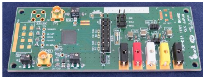
写真の説明：水中ロボットへ組み込むための試験基板で大きさは約5cm x 10cmである。評価用のため評価端子がのっているが、実機では搭載しない。
