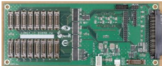
写真の説明：上の写真はCOMET実験ストロー飛跡検出器用読み出し回路(ROESTI)とデータ収集システムからの制御信号を分配するインターフェースボードです。
