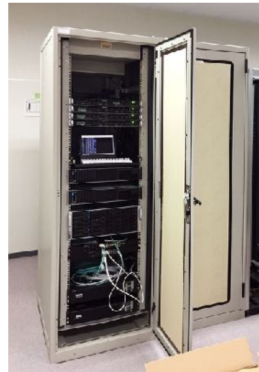
写真の説明：COMET データ収集システムの中心部であるコンピュータサーバーで、限られた予算内で実験に耐える速度(1GByte/sec)が出るように設計されている。
