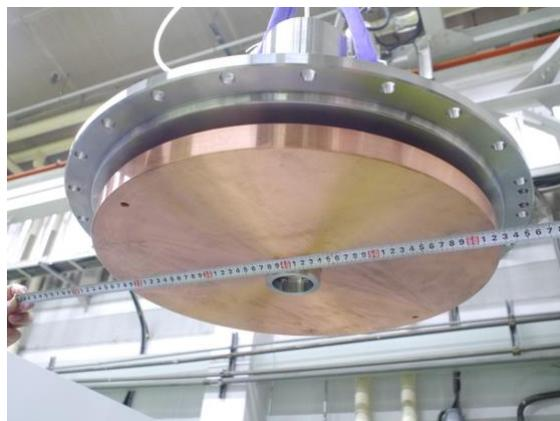
図 12: ダミーディスク取り付け改造中のターゲット試作機(2 段階シール)
