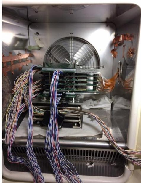
図 6: 恒温槽内の FPCCD センサー試験装置
