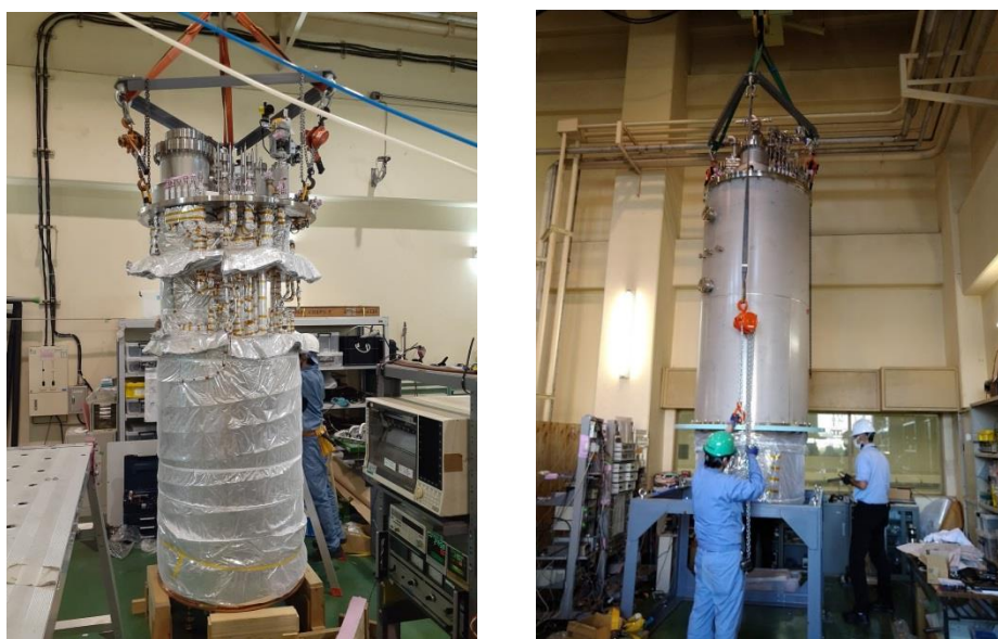
図 3 UCN 源を構成する熱交換器群（左）とクライオスタット組立作業（右）
