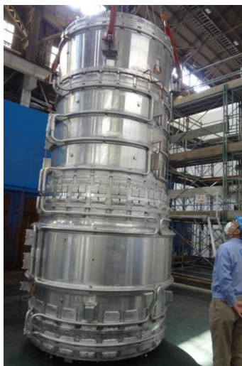
図 1 捕獲ソレノイド（左）と輸送ソレノイド直線部（右）のコールドマスが組み上がった。
