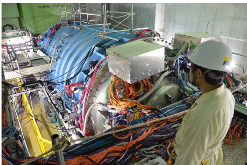
図3 J-PARCのハドロン実験施設にあるKOTO実験の測定装置。青色に塗られたタンクが真空容器。下流側から撮影。
