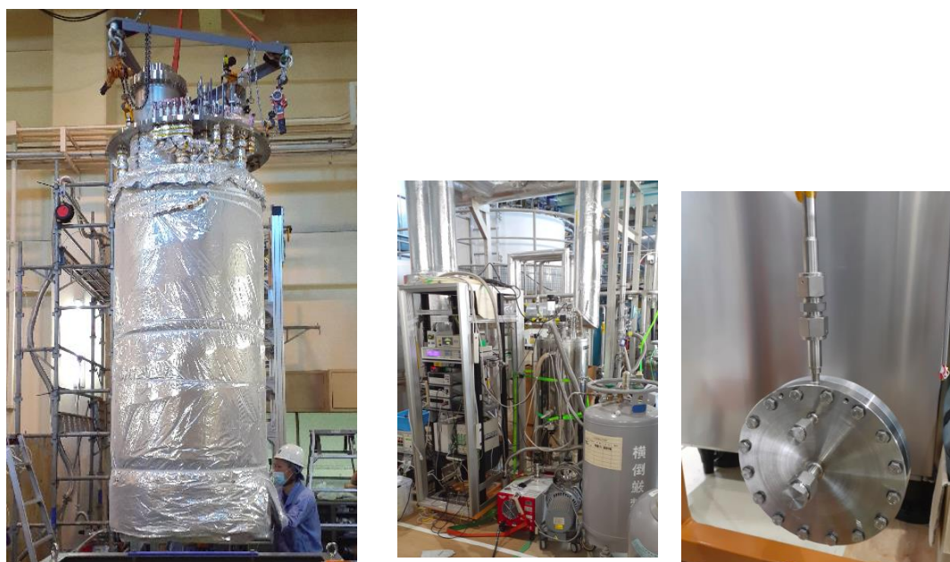
図2 左からヘリウム冷凍機、Al-SUS ジョイントスーパーリーク試験装置、Al-SUS ジョイント (TRIUMF デザイン)
