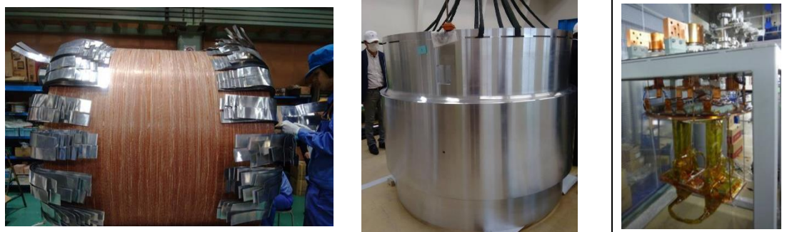
図3 左から捕獲ソレノイドコイルの1台 (CS1)、今年度 CS1 コイルの外周に嵌め合わせるアルミ合金製のサポートシェル。右端は試験中の捕獲ソレノイド用電流導入リードとそのテストベンチ。
