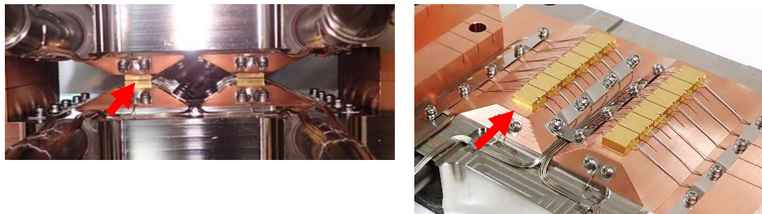
図2:(左)新生成標的を正面から見た写真。左右に2セットの標的が用意されていて、万一のトラブル時にはもう一方の標的にスイッチする可能性をもっている。(右)標的の下半分。金の標的(6x6x66mm)はビーム方向に6分割され、それぞれのブロックに左右から2つずつ熱電対が取り付けられている。
