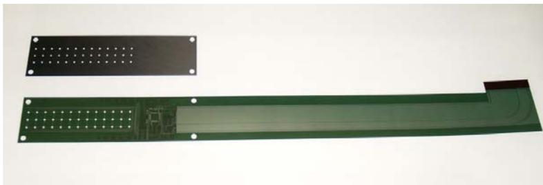
図 3 ラダー用 CFRP 板 (上) および FPC (下)
