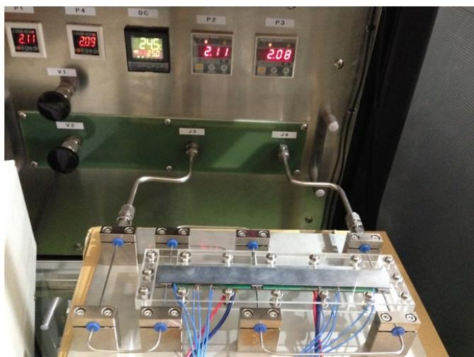
図 4 TPC 読み出しモックアップ冷却試験
