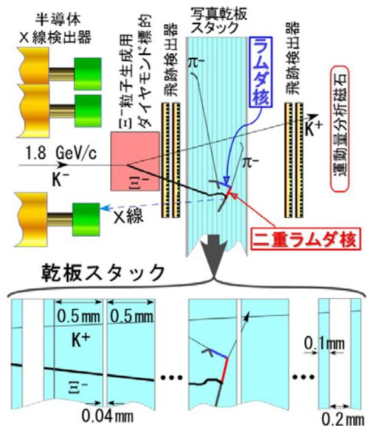
前段に置いたダイヤモンドの塊の中で、K<sup>+</sup>中間子の発生によりグザイマイナス（図中のΣ<sup>-</sup>）粒子の生成を捉えます。このK<sup>+</sup>中間子の発生は、後段の高位置精度の飛跡検出器と運動量分析磁石で確認されます。生成されたグザイマイナス粒子は、前段の飛跡検出器で、位置と角度が精度よく測定され、最もダイヤモンドに近い乾板での位置と角度が予測されます。
